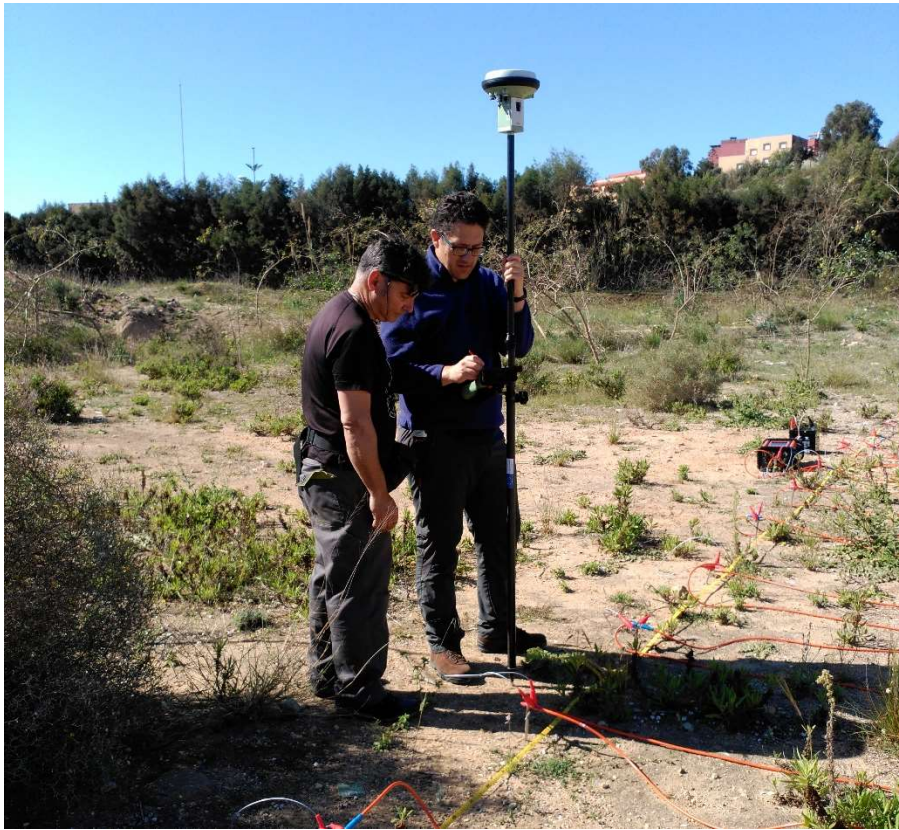
Figura 7: Posicionamiento de los electrodos mediante GPS diferencial.
