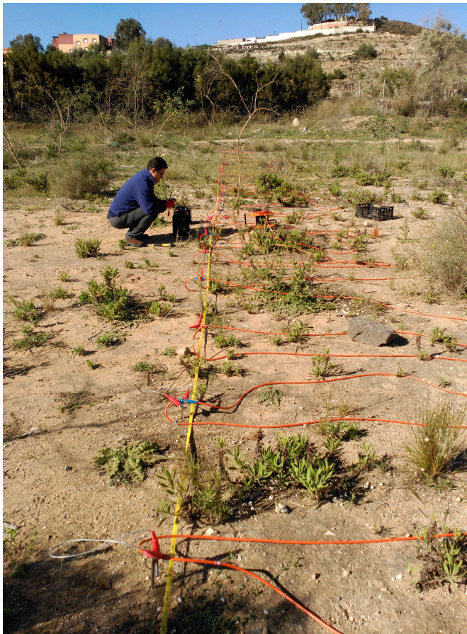
Figura 4: Disposición de los electrodos en el campo conectados al cable a lo largo del perfil nº 1.
